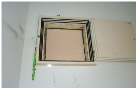
圖 2 迴響室試樣佈置圖(材料：木板)
