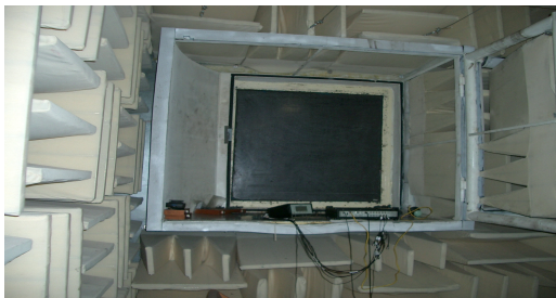
圖 3 無響室試樣佈置圖(材料：碳纖維板)
