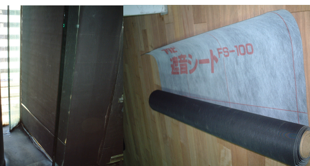
圖 14 以制振貼片改善玻璃帷幕表面振動量
