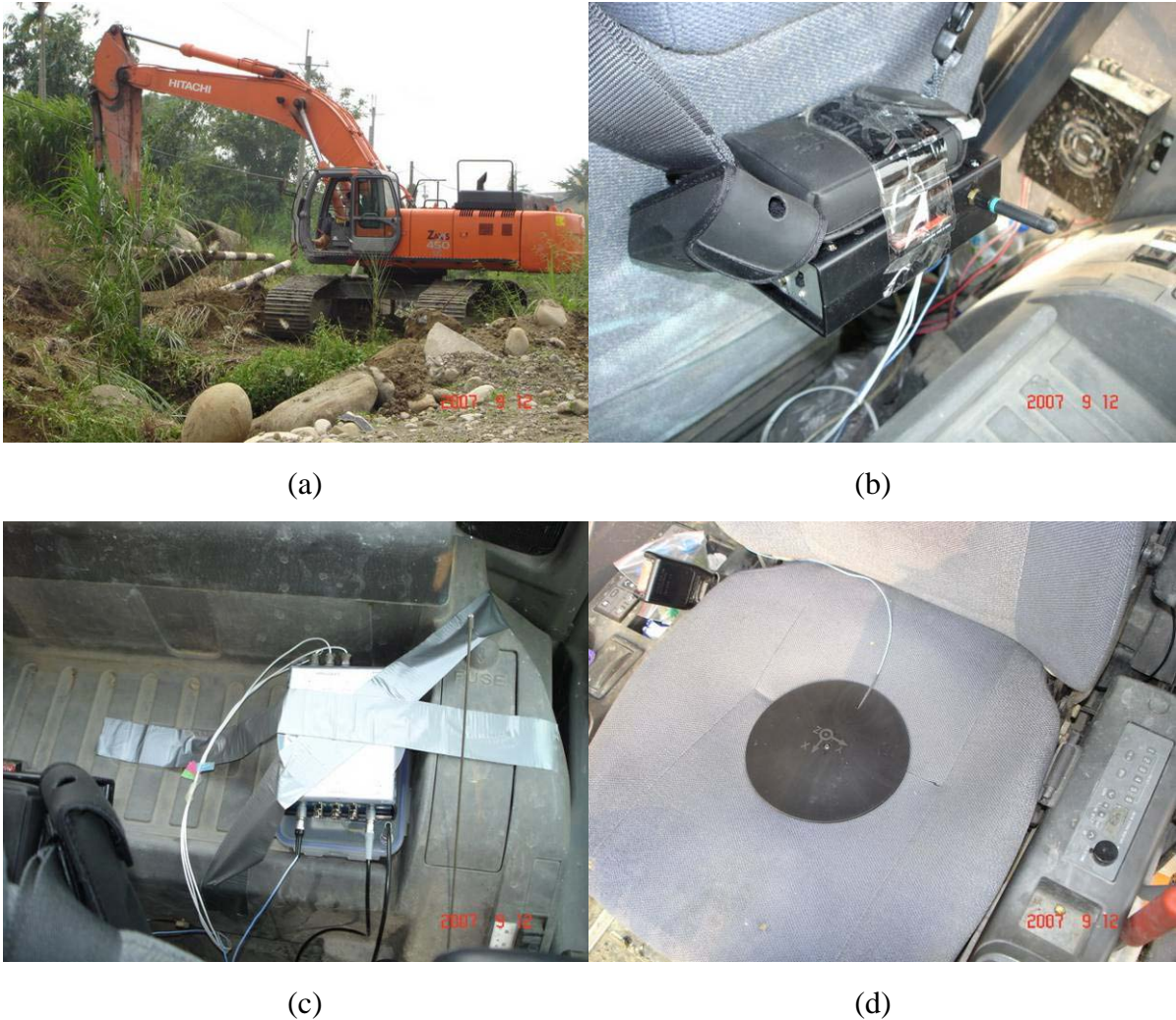
圖 4 現場測量實驗器材設置 (a) Mitsubishi 450 LC 挖土機溝渠挖掘 (b)記錄器吊掛於駕駛座椅背後方 (c)訊號放大器及電源電池固定於後座底面平台(d)席盤安置於座椅上臀部位置
