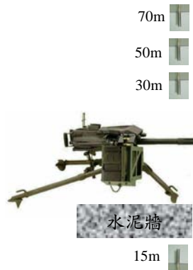
圖 12 小口徑武器射擊後側有屏障麥克風位置圖
