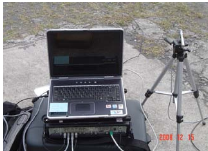
圖 8 訊號蒐集器材組成圖示
