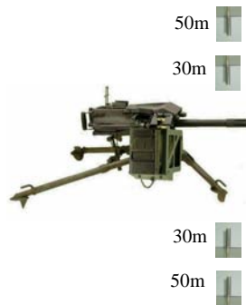
圖 13 小口徑武器射擊麥克風位置圖
