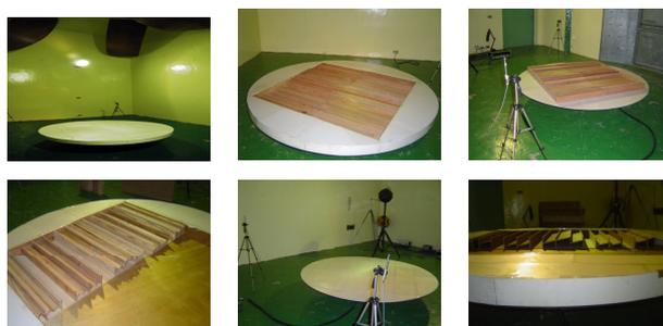
圖 3 試材之不同安裝方式
