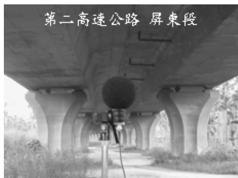
圖 6、在高架路伸縮縫底下進行量測
