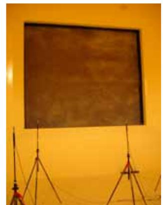
圖1 R4 音源室內部磚牆試體
