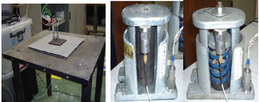
圖 15. 橡膠隔振器與金屬彈簧隔振器測試圖
