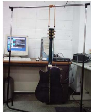
圖 5、吉他模態測試架構圖
