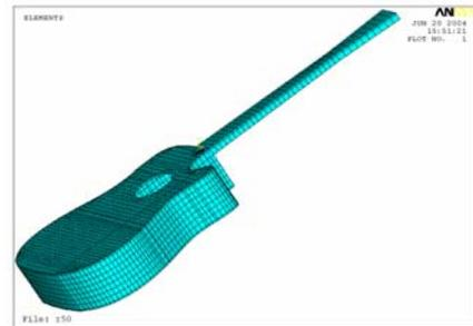
圖 3、吉他結構之有限元素模型
